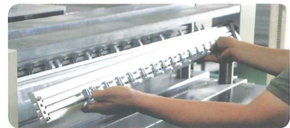
押さえゴムのフリーセッティング(事前準備) 抜型図面の寸法を確認して押さえゴムの位置を速く正確に決めることができます。
