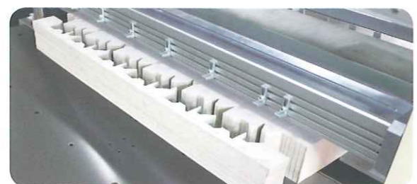
分離されたカス 打ち抜きが終わったパレット積みの紙を機械に入れるとカス取り工程を行なって綺麗にカスが取れます。
